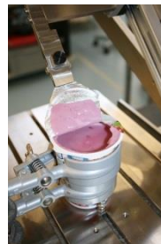
Kraftverlauf beim Öffnen eines Joghurtbechers
